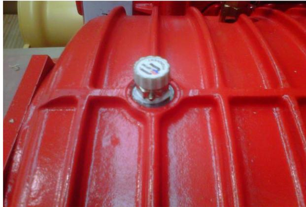
Este purgador permite la purga del aire dentro de la cámara de refrigeración durante el primer llenado y no debe ser manipulado a posteriori. Debe mantenerse en posición cerrada.
